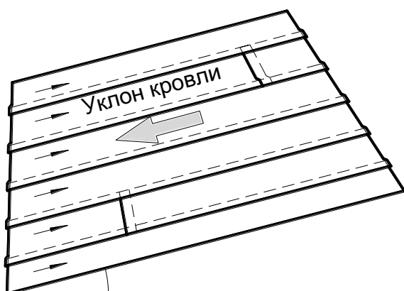
Рисунок Е. 2 — Укладка материала на скате кровли параллельно уклону
