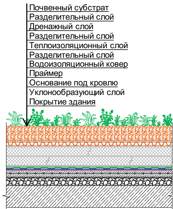
Рисунок 2.5 — Пример конструктивного решения кровли с озеленением
